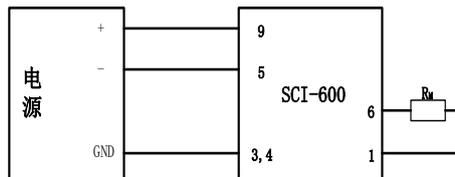
图 2 电气连接图
